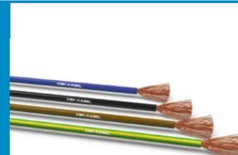
Diese Leitung ist bestimmt für die Verlegung im Installationsrohr auf oder unter Putz oder in vergleichbaren geschlossenen Systemen, speziell für Anwendungen, die im Brandfall eine geringe Entwicklung von Rauch und korrosiven Gasen erforderlich ist. Geeignet für feste und geschützte Verlegung in Geräten, in oder auf Leuchten oder Steuergeräten für Nennwechselspannung bis 1.000 V oder Gleichspannung bis 750 V gegen Erde.
